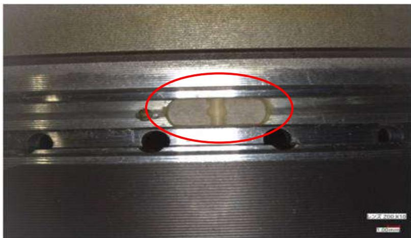
ピストンリング溝にセンサケースを取付けた状態のもの。
